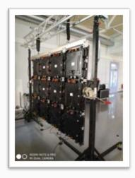
La cabina está fabricada con una aleación de aluminio y magnesio que nos asegura una estructura robusta y ligera.
